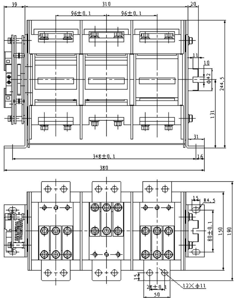
空气式换相开关的特点：体积小，容量大，结构简单，有明显的隔离断口，可替代进口产品。
